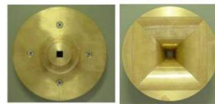
Fig.1 実験に使用した特殊ノズル
