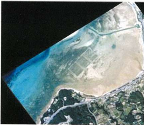
図2 航空写真画像解析による藻場やサンゴ分布の図例（左：原画像、右：解析画像—藻は緑色系、サンゴは紫、赤みのある砂地は橙色で表示）
