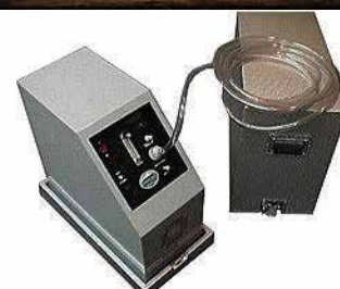
(写真: 4000m相当までの低酸素ガスを発生させる装置)
